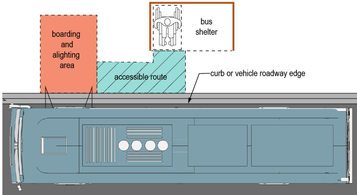
Figure 3.3 Accessible Route to/from Landing Area<sup>19</sup>
